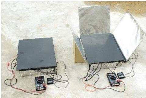
Gambar 5. Pengukuran menggunakan reflektor dan tanpa reflektor
